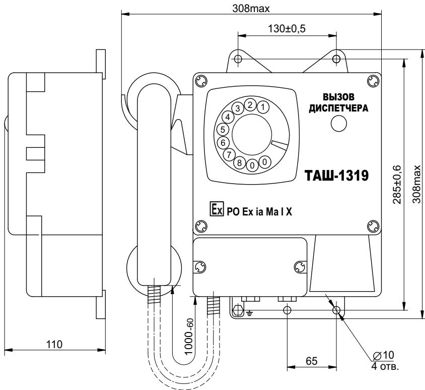
Рисунок 1. Аппарат телефонный шахтный ТАШ-1319.
