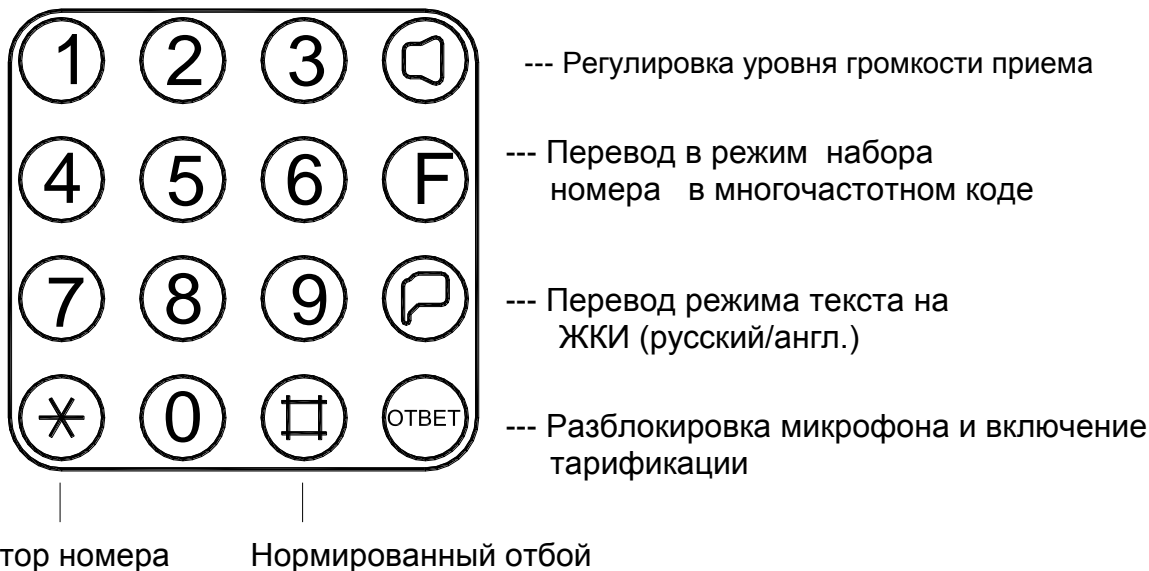
Рисунок 1.2 – Назначение кнопок номеронабирателя таксофона ТМГС-15280
