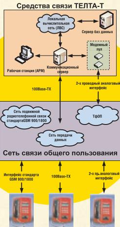
Комплекс таксофонного оборудования «Телта-Т» является системным техническим решением, обеспечивающим эксплуатацию модельного ряда таксофонов в телефонной сети общего пользования (ТфСОП) при безналичном способе оплаты разговоров и предоставляемых дополнительных услуг.
