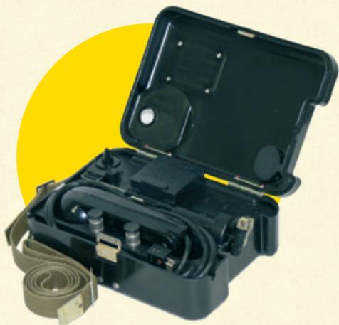
ТА-57 с индукторным вызовом предназначен для работы во временных помещениях, укрытиях и на открытом воздухе в режимах местной и центральной батареей по двухпроводным линиям связи.
