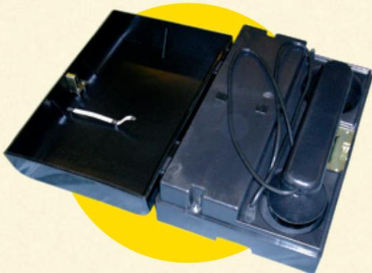
Аппарат телефонный постовой ТАП-2405 в настенном исполнении без номеронабирателя предназначен для совместной работы с коммутаторами ручного обслуживания СОС-30М, ПОС-90 и другими аналогичными коммутаторами с напряжением питания от 54 до 72 В при температуре окружающей среды от минус 40° до +45°С и относительной влажности воздуха до 98% при температуре 25°С.
