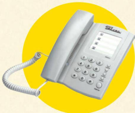
Телефонный аппарат с кнопочным номеронабирателем с набором номера в декадном и многочастотном коде, настольно-настенное исполнение. Обеспечивает хранение последнего набранного номера и его повторный набор. Имеет функцию отключения микрофона и удержания линии. Наличие акустического тонального сигнала вызова с возможностью регулирования уровня громкости. Оптическая индикация занятия линии.
